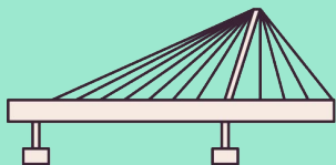
Puente atirantado (asimétrico)
