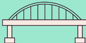
Puente en arco (tablero inferior)
